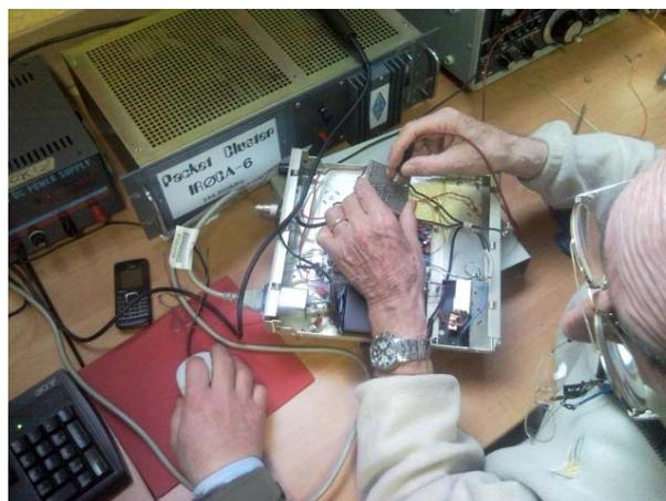
Riaperta la scatola si è disassiemati i vari componenti e si è fissata la basetta trasmittente, che nel primo tentativo era stata posizionata su una piastra di plexiglas, direttamente sul contenitore metallico, tramite due distanziatori di pochi millimetri.
